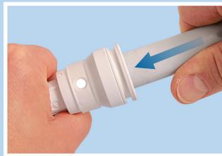
Zur Herstellung einer dichten Verbindung genügt es, das Verbindungsrohr so weit in den Fitting zu stecken, bis das **Kontrollfenster** weiß wird. Pressgeräte und Schraubenschlüssel sind nicht erforderlich.
