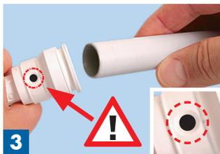
**3** Zusammenstecken – führen Sie das Rohr bis zum Anschlag in den Fitting ein.
