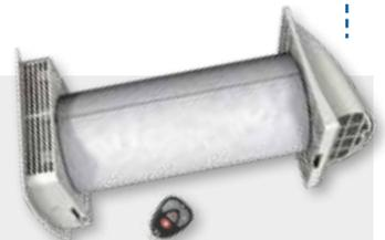
Der **Marley Frischluft-Wärmetauscher (MEnV 180)** ist ein dezentrales Lüftungssystem ideal für Wohn- und Schlafräume in wärmegeprägten Häusern. Ein innovatives Keramikelement speichert die Wärme der Abluft und gibt sie an die kalte, einströmende Frischluft ab. Frische Luft strömt zugfrei und gefiltert ein. Verbrauchte Luft wird zuverlässig nach außen abgeführt und so der Bildung von Feuchtigkeit vorgebeugt.
