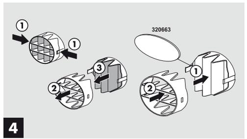
4 Filterpatrone öffnen und Filter reinigen (nicht auswaschen) oder austauschen.
