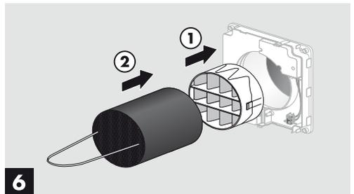
6 Hauptrohr auf Verunreinigungen untersuchen und diese ggf. mit feuchtem Tuch beseitigen. Alle Komponenten wieder einbauen und Gerät anschließend erneut in Betrieb nehmen.
