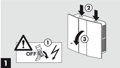
1 Gerät von der Stromzufuhr trennen.
